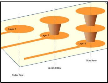
Figure 3. Microvia Fan-Out
